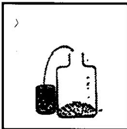
5. Abgemessene 100ml Substratprobe in eine 500-ml-Kunststoff-Weithalsflasche füllen.
