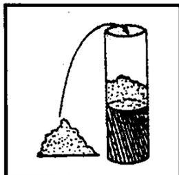
2. Repräsentative Substratprobe bis zum oberen Hülsenrand locker einfüllen.
