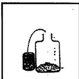
5. Abgemessene 100ml Substratprobe in eine 1-ltr-Kunststoff-Weithalsflasche füllen.
