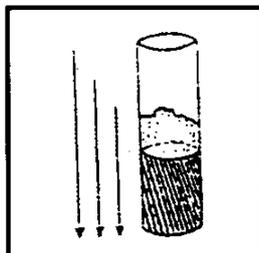
3. Zur Verdichtung den Messbecher 10x auf einer festen Unterlage aufstoßen.
