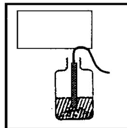
7. Nach 1h pH-Wert in der Suspension mit pH-Elektrode messen.
