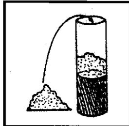
2. Repräsentative Substratprobe bis zum oberen Hülsenrand locker einfüllen.
