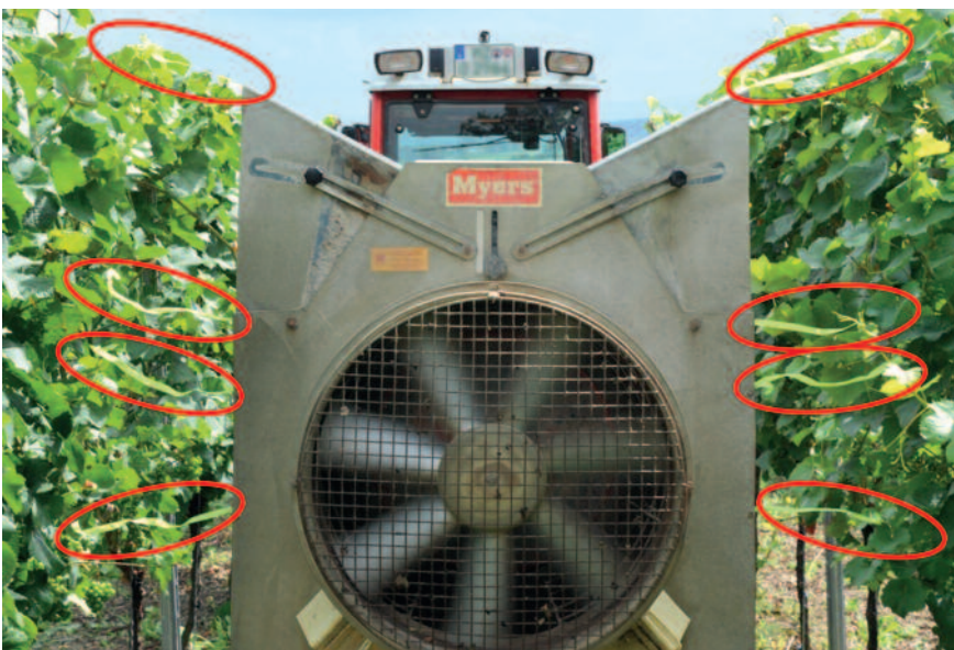
Richtiges Einstellen der Luftleitbleche auf die Kultur. Exakte Ausrichtung sorgt für einen optimalen Luftstrom und reduziert die Abdrift. Der Luftstrom wurde mit einem Flutterband sichtbar gemacht
