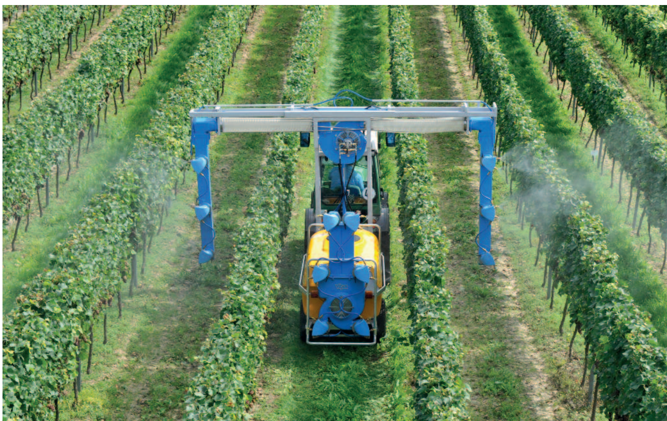
Hohlkegeldüsen – deutlich sichtbar sind die feinen Tropfen, die allerdings vom Wind leichter verdriftet werden können
