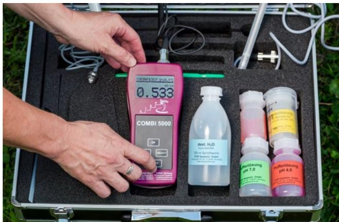
Das COMBI 5000 ist ein Universal-Gerät für die Sofortmessung der wichtigsten Parameter in der Pflanzenproduktion.
