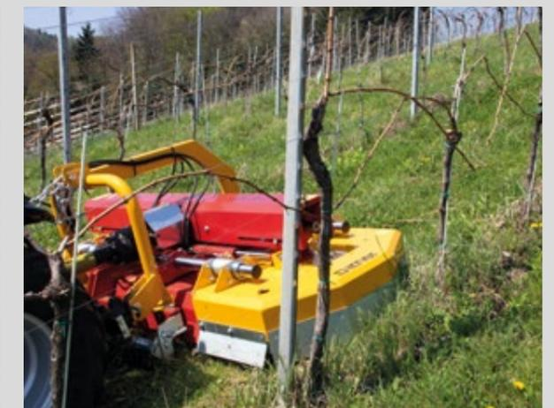
Dank Pendelrahmen wird das Gewicht des gesamten Mulchgerätes optimal auf den Traktor übertragen.
