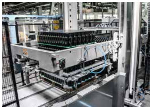
Der automatische Depalettierer TMG Modell VEGA 120A bildet den Ausgangspunkt der neuen Hochleistungslinie, die sich aktuell in Fertigung befindet
