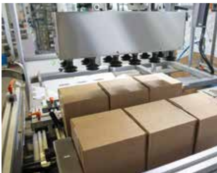
Feststehender Greiferkopf für die Formation 1x3
