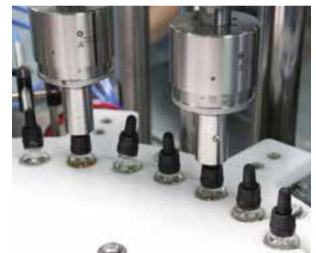
Verschließerköpfe mit magnetischer Kupplung und einstellbarem Drehmoment
