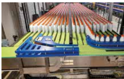
Am Ende der Akkumulationsphase sind alle 20 Kanäle auf dem Tisch gefüllt
