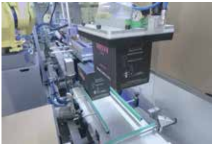
Schaumgummi-Greiferkopf zur Aufnahme und Palettierung der Kartons
