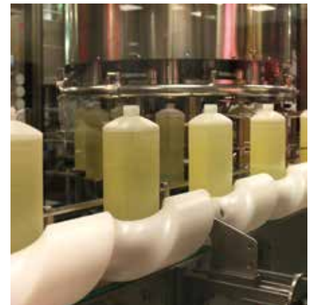
Transportschnecke zwischen Füller und Verschleißer
