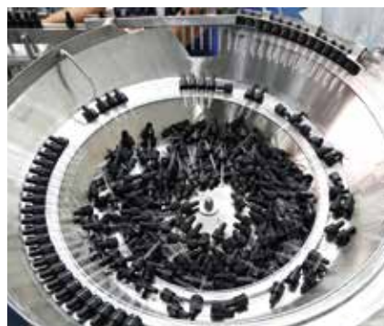
Zwei vibrierende Untergestelle und zwei Behälter aus Edelstahl befördern die Verschlüsse zum Verschließer
