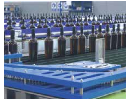
Druck- und berührungsfreier Transport von Glasflaschen – nahezu lautlos!
