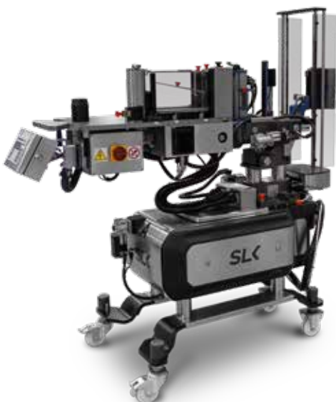
SLK-Wagen zur externen Installation der Etikettiereinheiten
