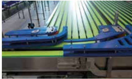
Zwei Einlaufwagen zur Beschickung des 20-Kanal-Tisches
