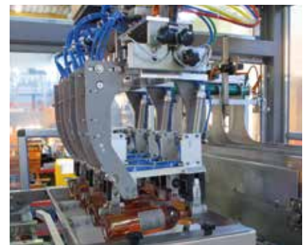
Nur einige Beispiele der möglichen Greiferkopf-Ausstattungen: zum Greifen von Kanistern (oben), Triggerflaschen (Mitte) oder zur horizontalen Verpackung von Flaschen (unten)
