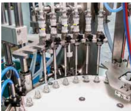
Der Stern positioniert die Behälter unter den volumetrischen Einspritzdüsen
