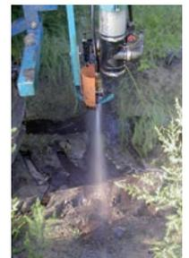
Düsengröße anhand folgender Auswahlkriterien ermitteln: Flüssigkeitsaufwand, Fahrgeschwindigkeit sowie empfohlener Spritzdruck des Düsentyps.
